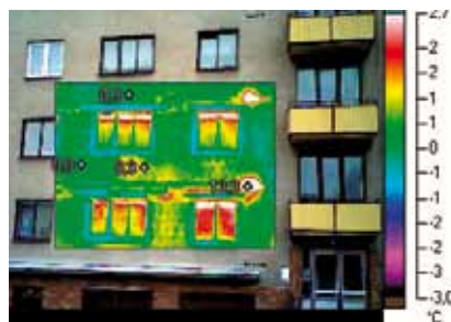
Teplo unikajúce z okien.
